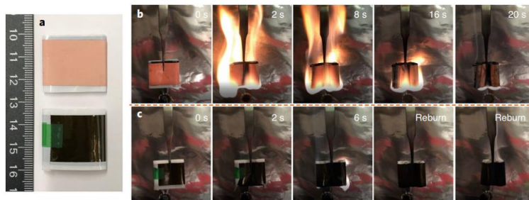
图表：使用复合集流体的电池抗燃性极高
