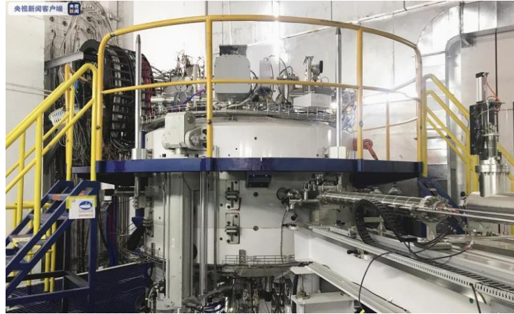
图27 国产最紧凑型超导回旋质子加速器
