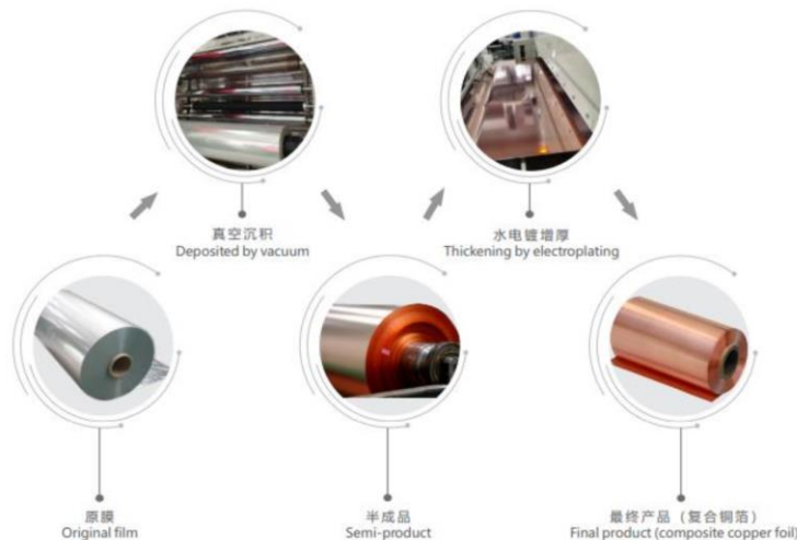
图表：复合集流体两步法生产工艺
