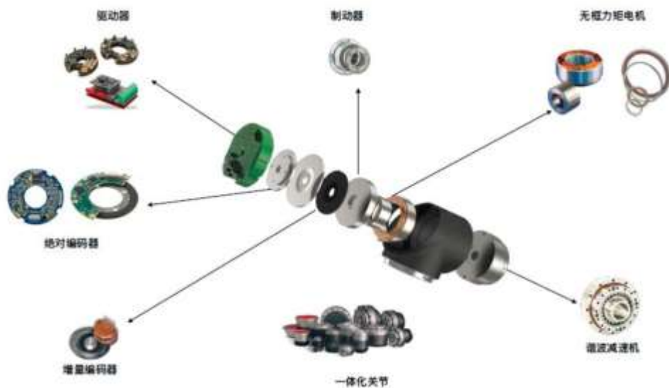
图21：特斯拉机器人旋转关节类似科尔摩根为协作机器人提供的关节模组
