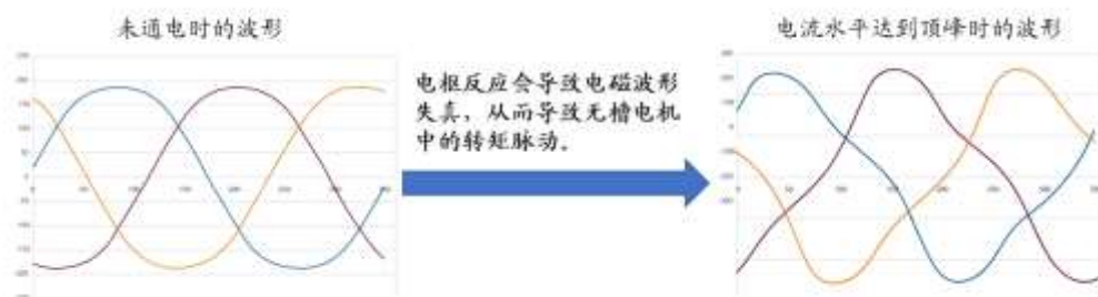
图9：电枢反应导致电磁波形失真，从而导致无槽电机中的转矩脉动
