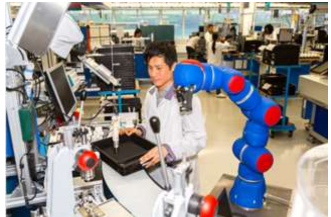
图14：协作机器人关节中采用了 Maxon 无框电机
