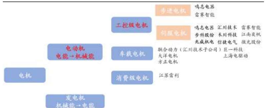
图1：电动机可分为工控级、消费级、车载电机
