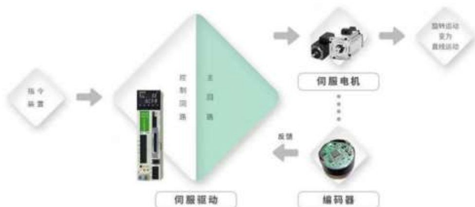
图8：反馈闭环是通过编码器检测电机转速和旋转角度并反馈给控制器的控制方法
