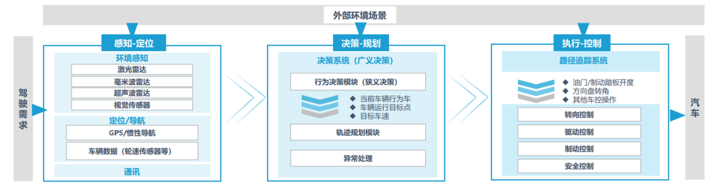
图 31：智能驾驶系统功能架构
