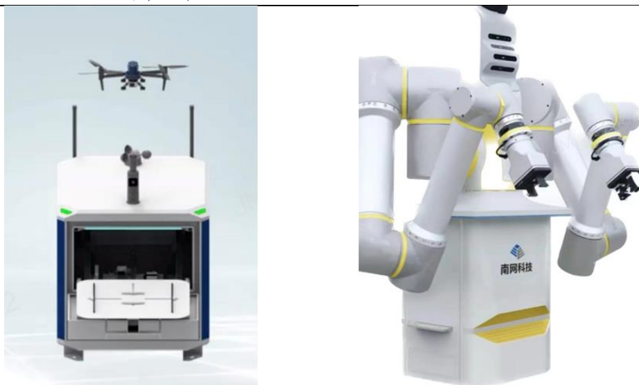
图表 19 公司巡检与带电作业机器人
