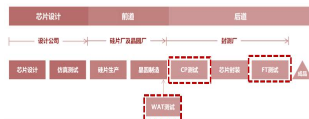
图 16：电性检测主要包括 WAT、CP、FT 测试
