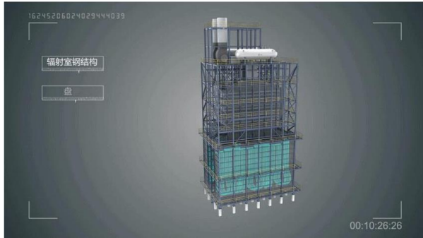
图表 14：辐射段模块是乙烯裂解炉的核心部件
