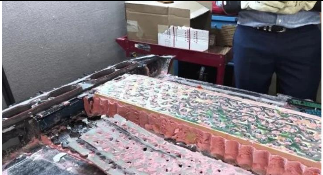
图 9：4680 采用蛇形冷却板
