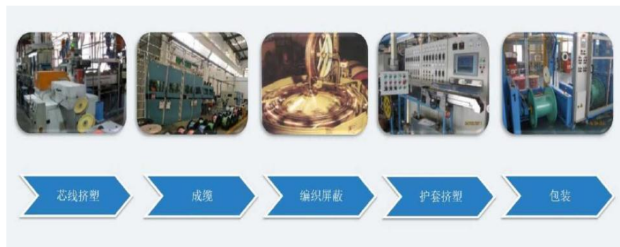
图 15：汽车导线到线缆生产工艺概况
