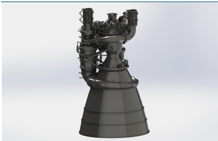
图表24：“朱雀二号”采用自研的“天鹅”真空型发动机 TQ-15A
