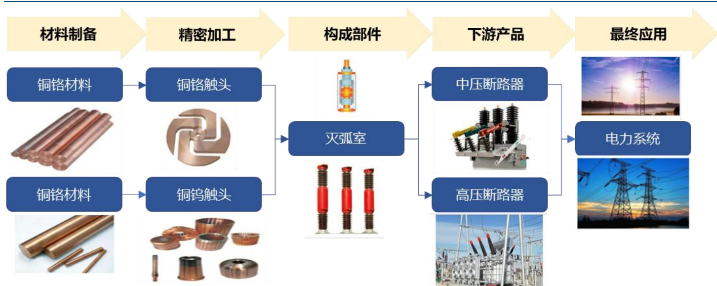
图表28：公司铜基触头产品用于中高压断路器真空灭弧室
