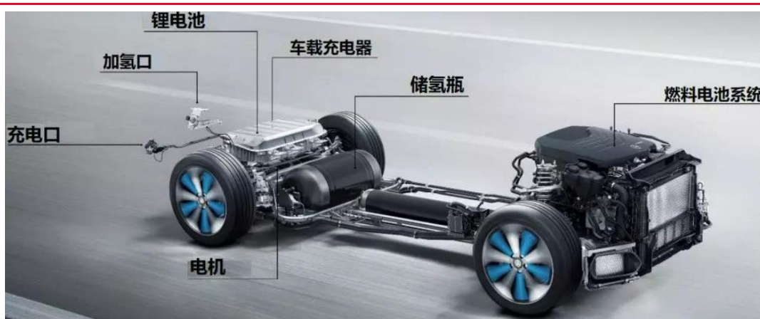
图36 奔驰 GLC F-Cell 氢燃料电池车动力系统结构示意图
