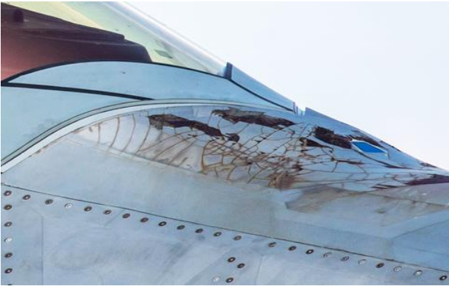
图 15: F22 飞机上的裂纹 (易耗品-隐身材料)
