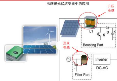
图表71：电感在光伏逆变器中的应用
