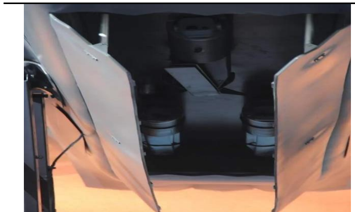
图10：埋于 FH-97 弹舱内的 FH-901 巡飞弹
