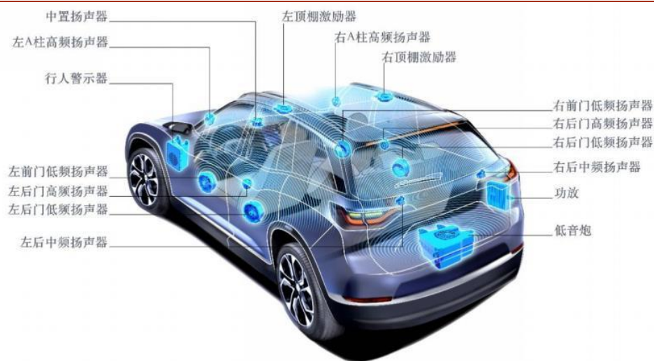
图15：汽车音响系统主要部件分布
