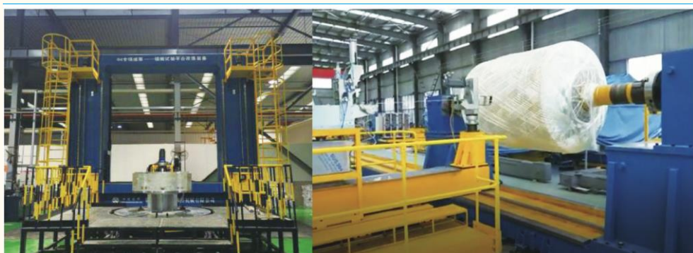
图表 33：航天系统应用华中 8 型数控系统铺丝铺带机
