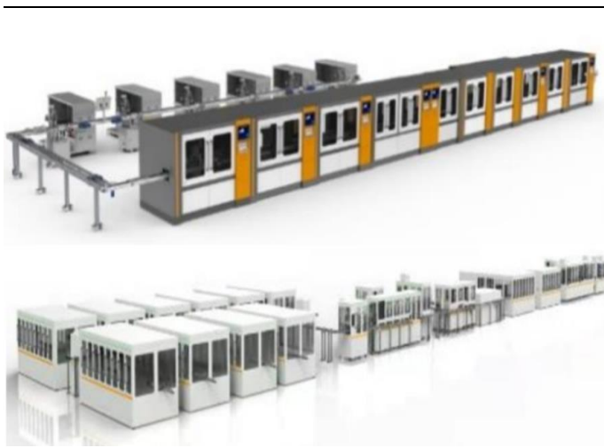
图13：电芯高速装配设备主要应用于圆柱电池
