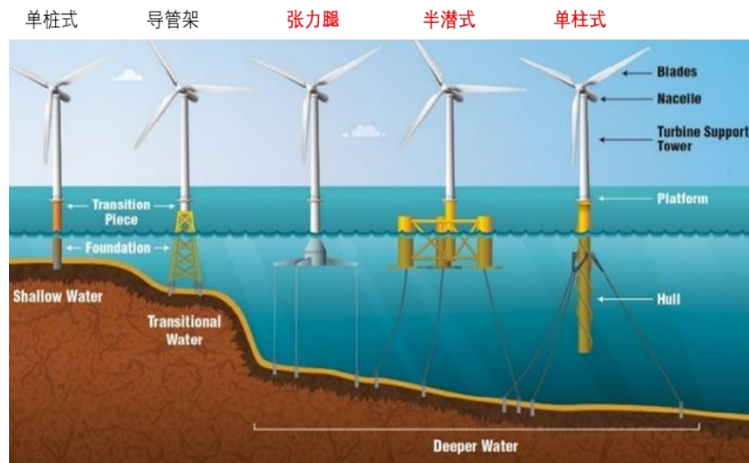
适应不同水深的海上风电基础结构示意图
