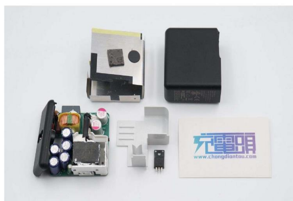
图62：赛尔康 60W PD 快充充电器拆解
