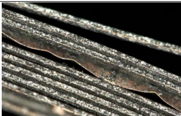
图 14: 卷绕工序需要保障正负极片和隔膜的对齐度
