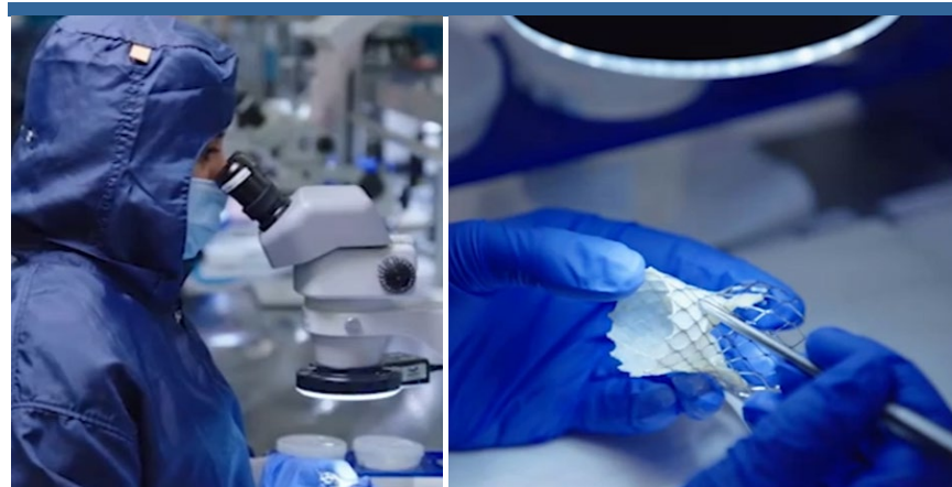
图表.美敦力TAVR纯手工缝合过程
