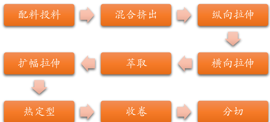
图 37 湿法隔膜生产工艺流程
