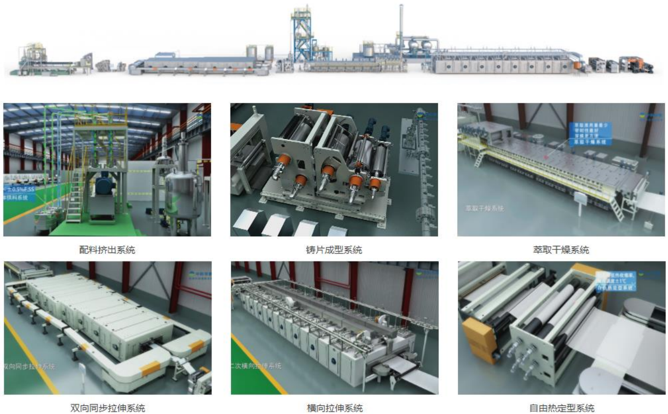
图 38 湿法隔膜生产线图例
