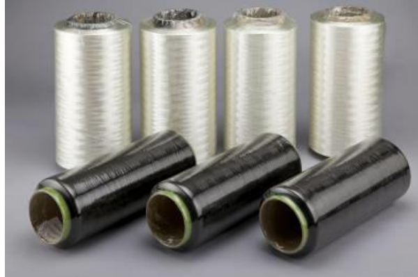
图1.原丝及碳纤维图例（白色的为碳纤维原丝，黑色的为碳纤维碳丝）
