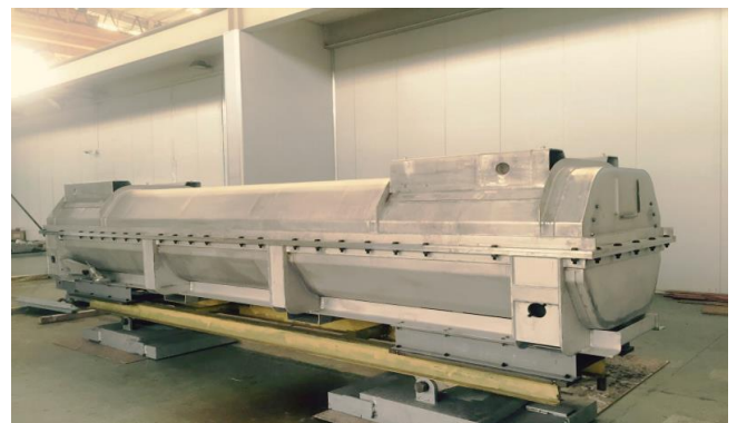
图28：公司 ANT-12A 型新燃料运输容器实现国产替代
