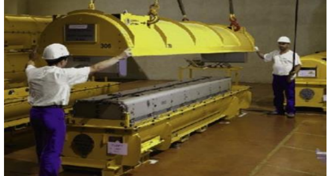
图16：台山核电站引进法国 FCC4 型运输容器
