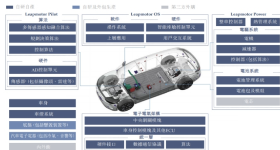
图 47：零跑汽车自研自制的核心系统及电子部件
