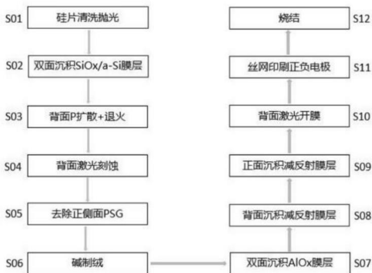
图表 21：改良后的 P 型 IBC 产线需要 12 步
