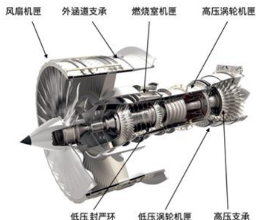
图表 179: 锻造件在航空发动机中的应用部位
