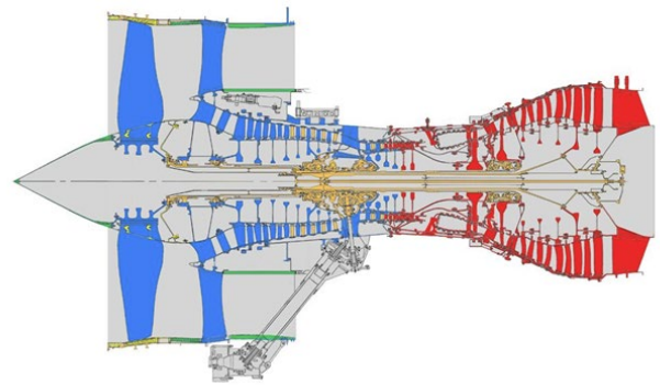
图表 114: 先进航空发动机中高温合金使用部位
