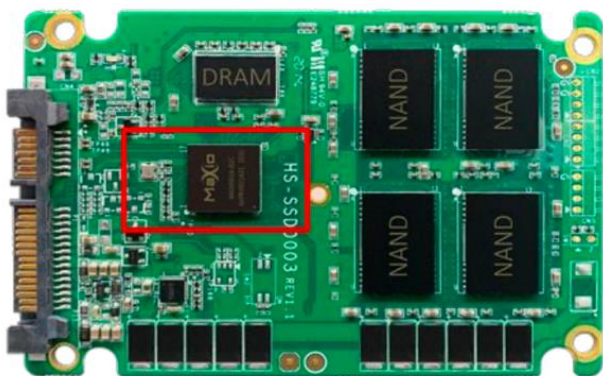
SATA 接口固态硬盘内部构造图
