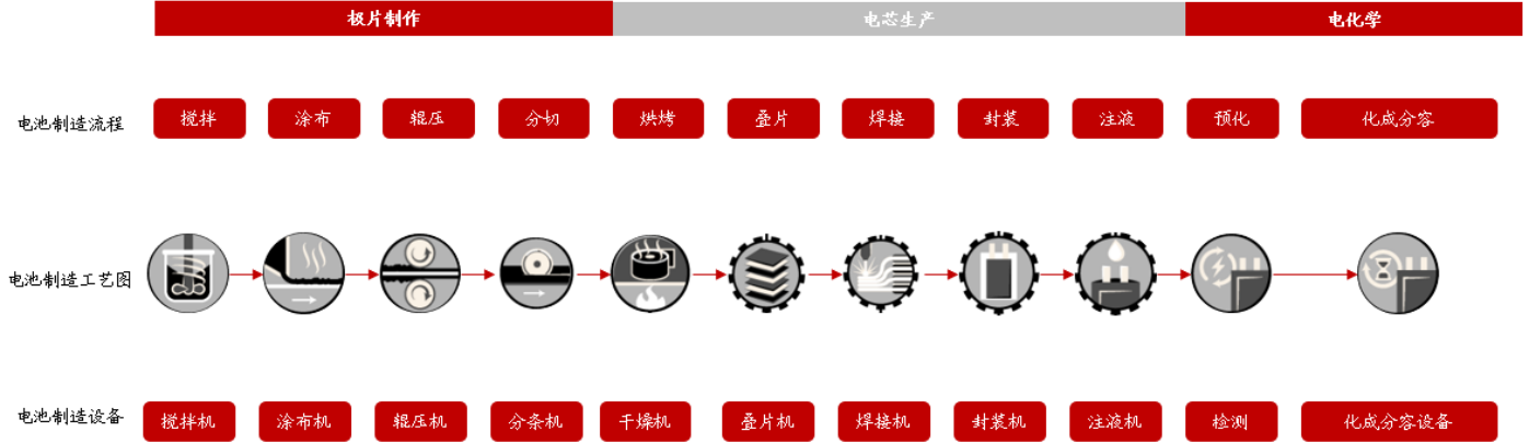
图3：钠离子电池技术工艺（与锂离子电池工艺、设备兼容）
