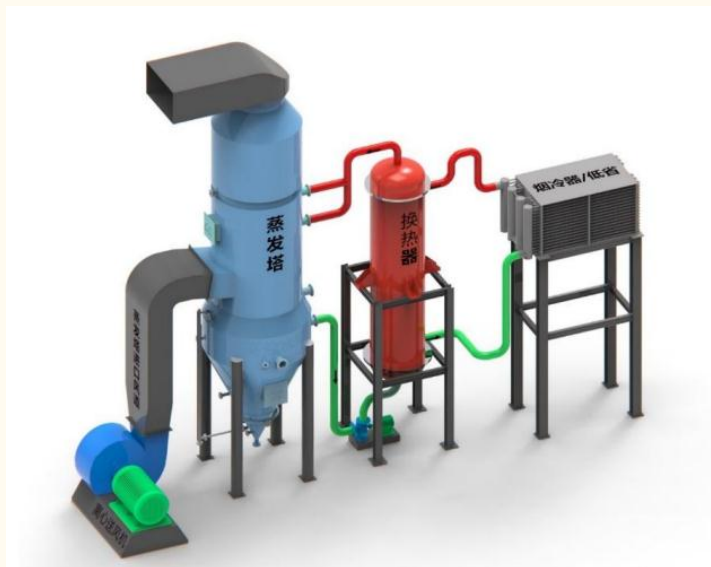
图表 41：脱硫废水环保处理系统浓缩减量阶段示意图
