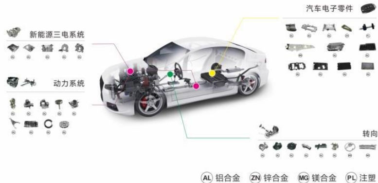
图17：公司精密压铸产品在汽车的应用领域示意图
