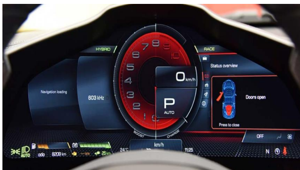
图1：15.6 英寸异形曲面背光显示模组
