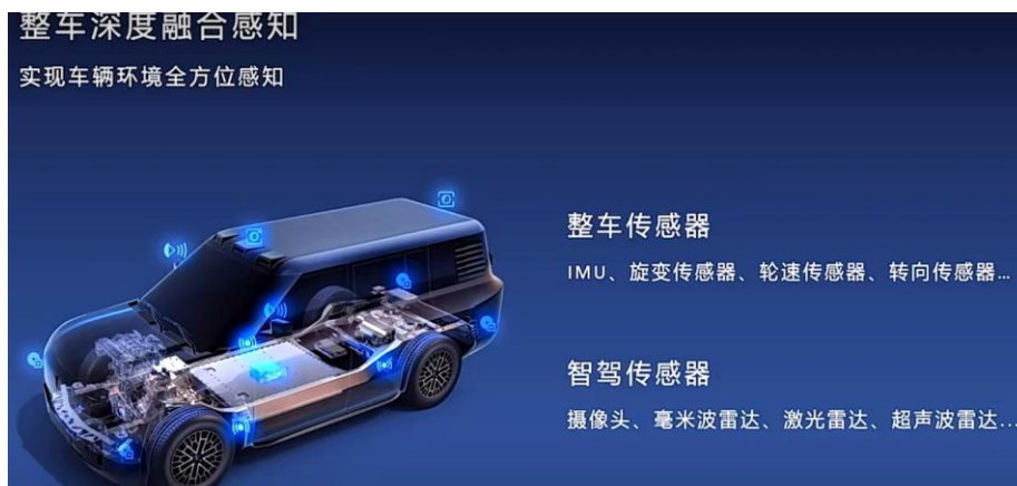
图表5 “易四方”平台车型搭载的传感器
