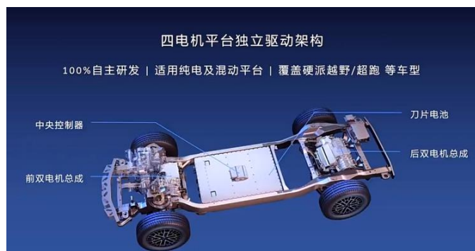
图表 3 “易四方”四电机独立驱动架构
