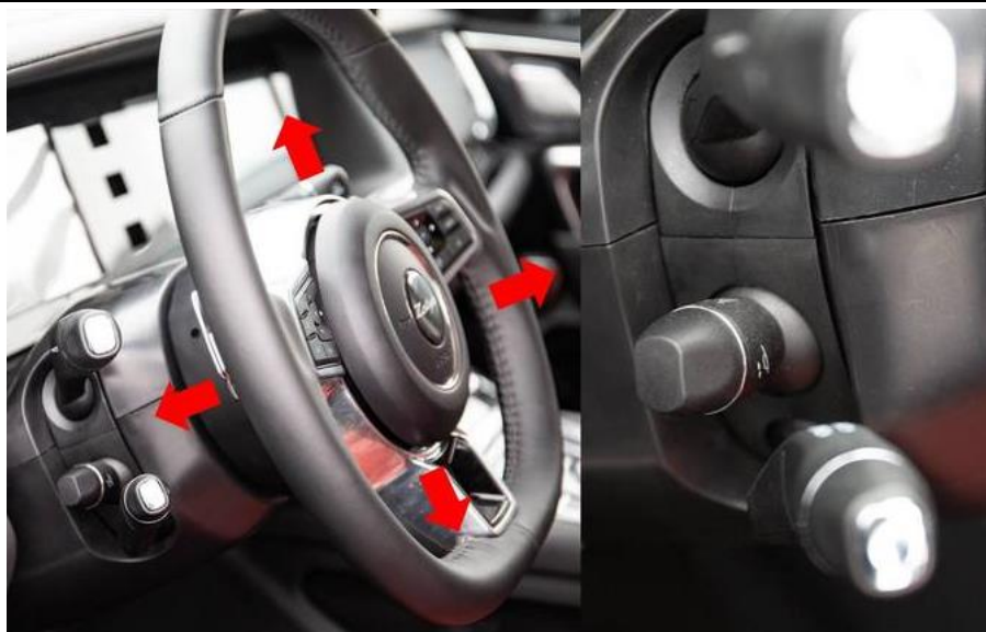
图25：电调方向盘是指方向盘的调节通过电机来实现
