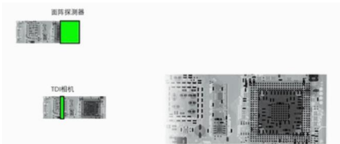
图 65：TDI 相对于面阵探测器极大提高检测效率
