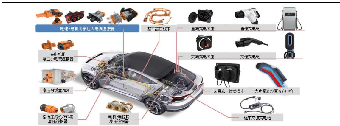
图31：公司新能源汽车业务产品主要集中在高压大电流应用场景
