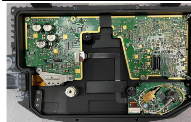
图46: 图达通激光雷达光源采用光纤激光器
