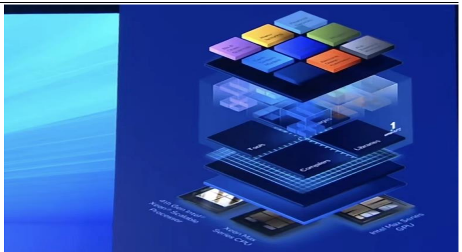
图表 8 英特尔 Max 系列 GPU 采用 3D 封装 Chiplet 技术，在单个产品上整合 47 个小芯片
