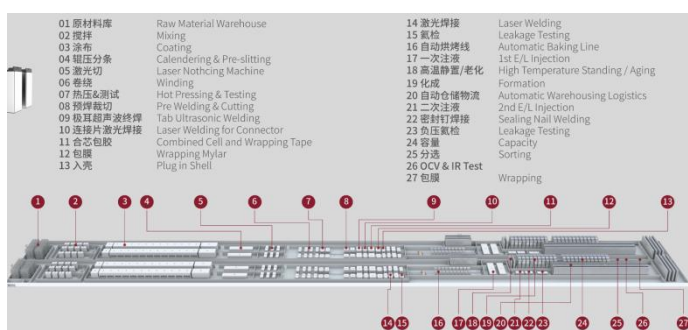
图 50：利元亨方形动力电池整线
