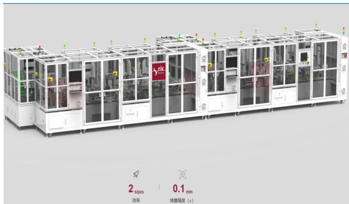
图 62：公司燃料电池电堆装配线
