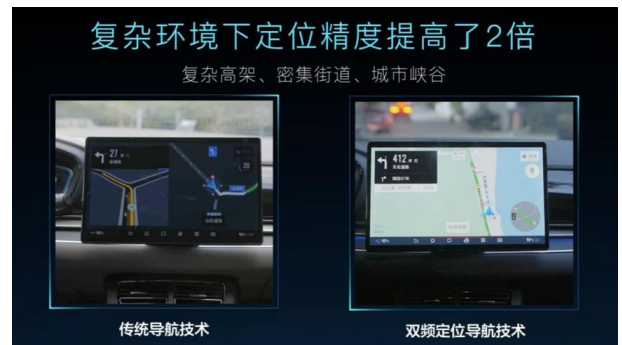
图表 65: 比亚迪 DiLink 4.0 (5G) 的双频定位导航技术
