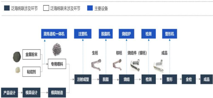
图3：公司 MIM 工艺流程
