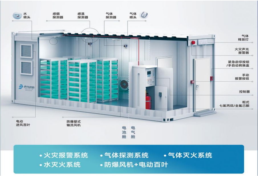
图34：舱级储能消防系统构成
