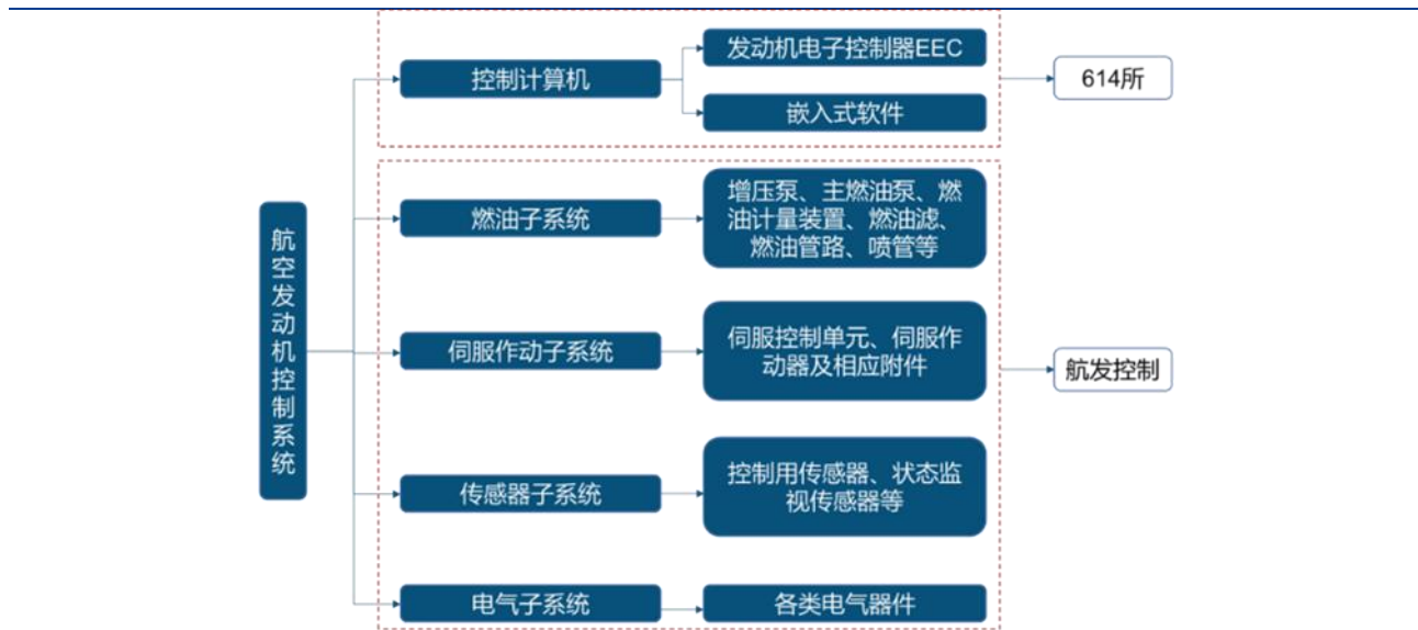
图83 发动机控制系统构成
