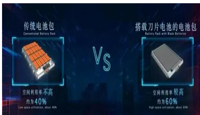
图表 18 比亚迪刀片电池包跳过模组，利用率提高 50%
