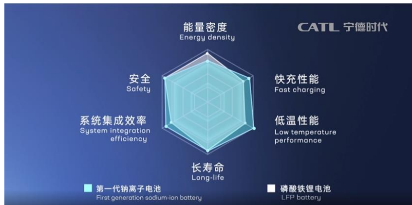
图11：宁德时代第一代钠离子电池与磷酸铁锂电池性能指标对比图
