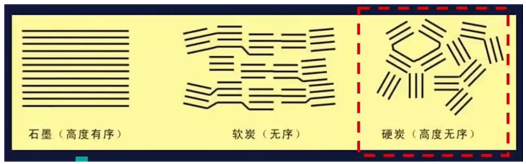
图7：石墨、软碳和硬碳的微观结构
