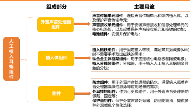
图 33：人工植入耳蜗组件各主要部分用途
