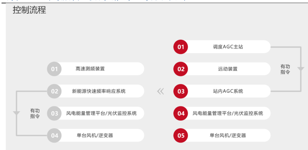
图表 18 公司新能源快速频率响应系统解决方案流程
