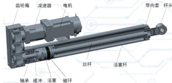
图表42：电动缸组成部分
